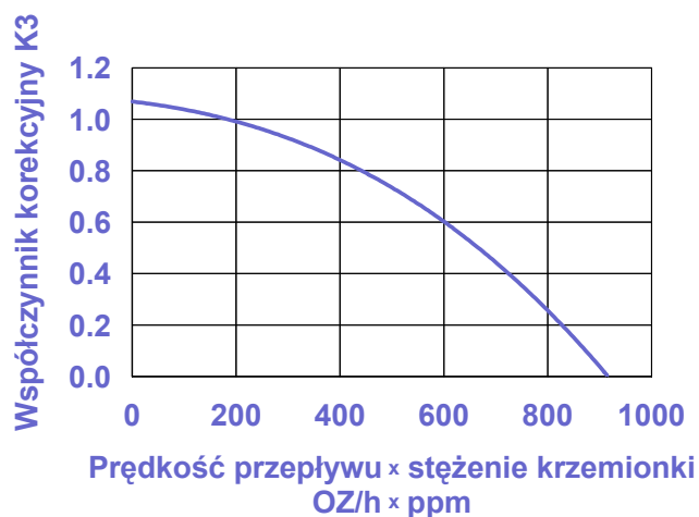
Rys. 8. Poślizg krzemionki w funkcji obciążenia kinetycznego
